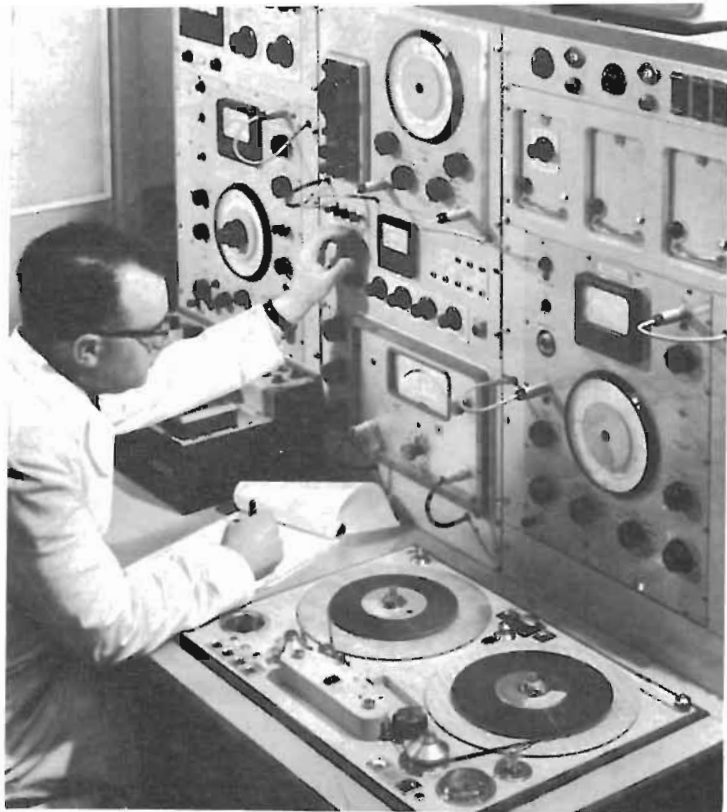
Photo 11 Vérification des propriétés de la bande magnétique.
