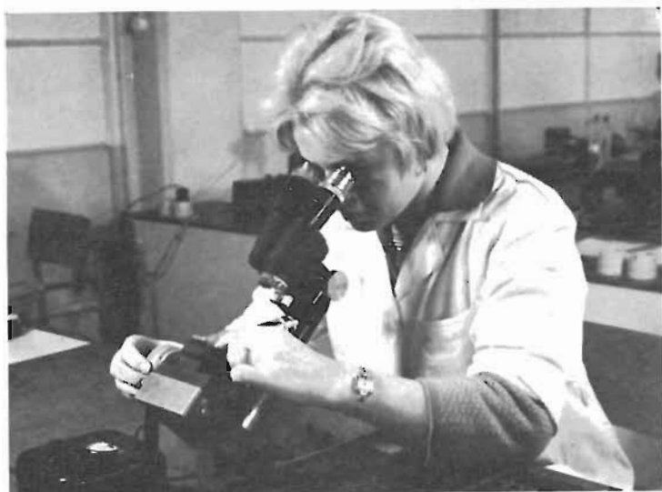
Photo 9 Contrôle des dimensions et de l'alignement de l'entrefers dans la tête magnétique.
